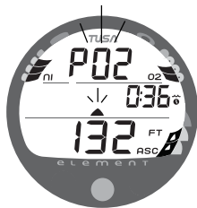
Fig. 48 - HIGH PO2 ALARM
