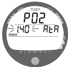
Fig. 22 - SET PO2 ALARM
